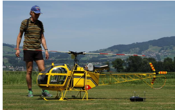
Urs Schirmer mit Spitfire, SpW 258 cm, Gewicht 16,4 kg, Motor 80 ccm, Theo Fähr mit Heli LAMA (SA3158), Massstab 1:4, Rotordurchmesser 240 cm, Gewicht 18 kg, Turbine Leistung 5kW auf der Abtriebswelle.
