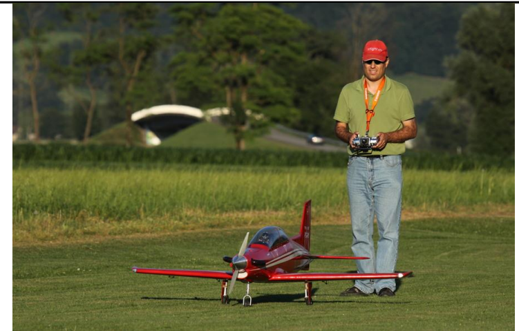
Modell PC-21 von Reto Diethelm, Antrieb Scorpion 5535-190, LiPo 12S 5500 mAh, Spannweite 180 cm, Länge 211 cm, Gewicht 9.3 kg
