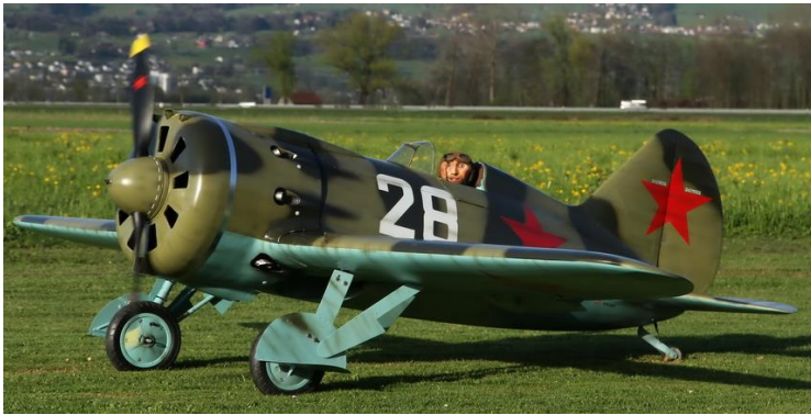
Scale Modell Polikarpov "Rata" I-16/24 von Rolf Schönenberger. Spannweite 330 cm, Motorisierung 400 ccm 5-Zylinder 4-Takt, Gewicht 35 kg
